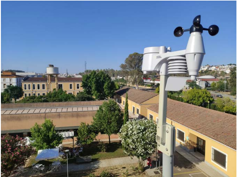
Figura 2: detalle de la instalación de la estación de la EIA (Badajoz) (J. Morillo)
