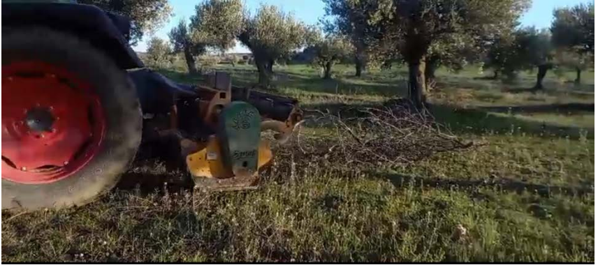
Figura 7. Trituradora de martillos actuando sobre restos de poda. (M. Videgain)
