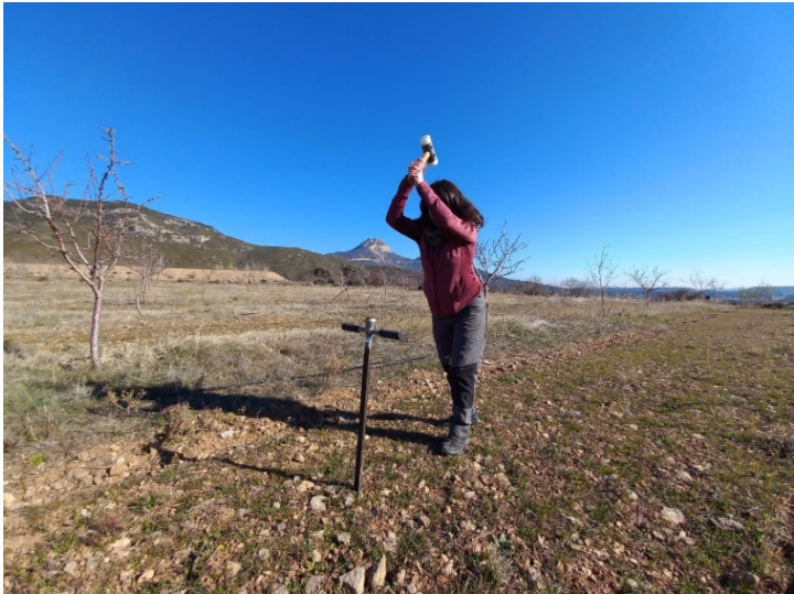
Figura 5. Muestreo de suelo con barrena de caña cilíndrica. (M. Videgain)
